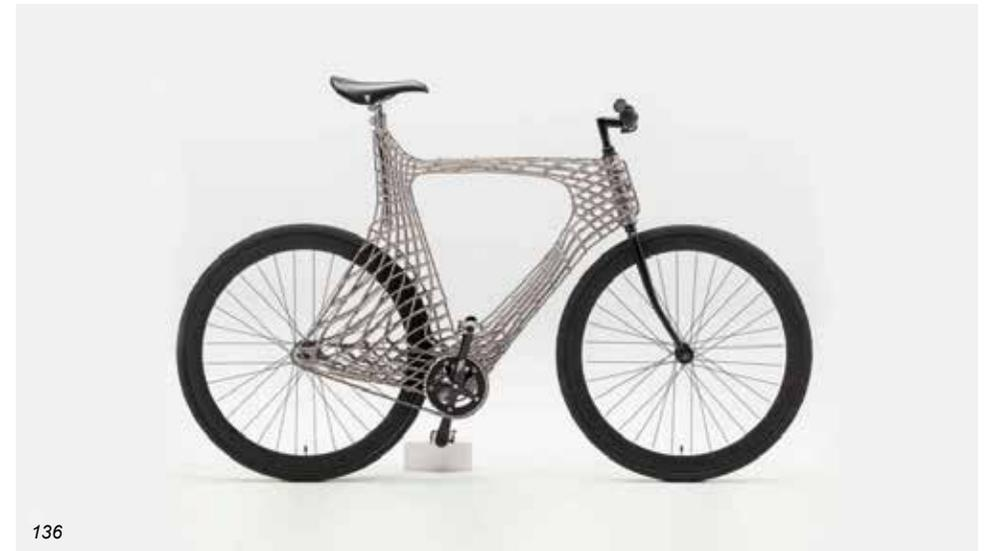
Studenten der TU Delft entwickeln ein Fahrrad, dessen Rahmen im 3-D-Drucker gefertigt wird.
